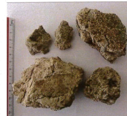
Εικ. 7α-γ Το δείγμα OB2 και τα αδρανή του μετά το διαχωρισμό εικόνα μικροσκοπίου 10X με τα αδρανή μετά τον υγρό διαχωρισμό.
