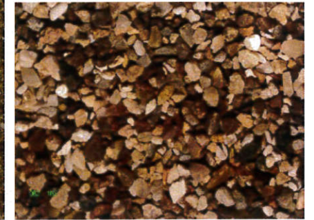
Εικ. 7α-γ Το δείγμα OB2 και τα αδρανή του μετά το διαχωρισμό εικόνα μικροσκοπίου 10X με τα αδρανή μετά τον υγρό διαχωρισμό.
