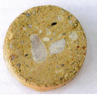
Εικ. 11 Κονίαμα δομής ΑΜΥ2Χβ ασβεστοκονιάματος.
