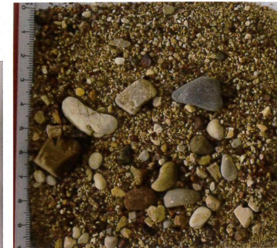
Εικ. 7α-γ Το δείγμα OB2 και τα αδρανή του μετά το διαχωρισμό εικόνα μικροσκοπίου 10X με τα αδρανή μετά τον υγρό διαχωρισμό.
